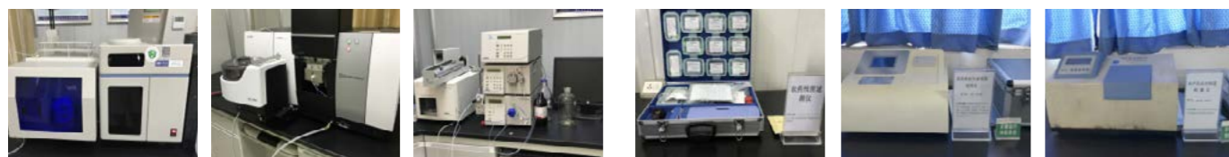
原子荧光分光光度计 原子吸收光谱仪 高效液相色谱仪 农药残留速测仪 兽药及抗生素残留检测仪 农产品安全快速检测仪
